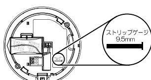
②電線を差込端子に正しく接続してください。
